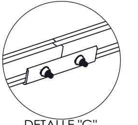
DETALLE "G" NXT-RS Empalme de riel RX
